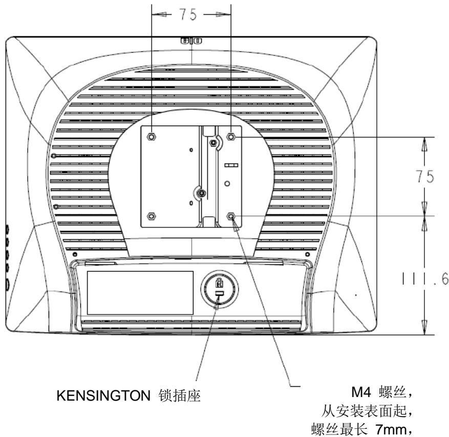
对于 17-英寸触摸显示器，显示器后部提供了一个可拧入 M4 螺丝的四孔 100x100mm 安装面。使用十字螺丝刀卸下支架，以便露出该安装面。符合 VESA FDMI 标准的安装编码为：VESA MIS-D, 100, C。
