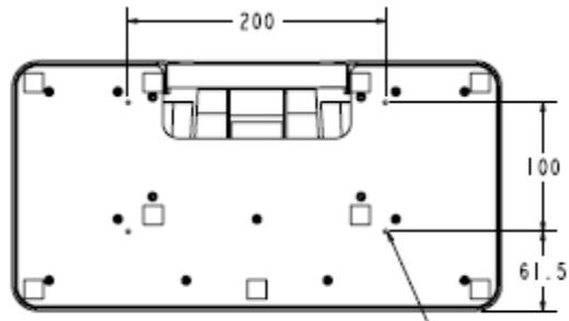
M4-GEWINDE, MAX. SCHRAUBENTIEFE 7 mm
