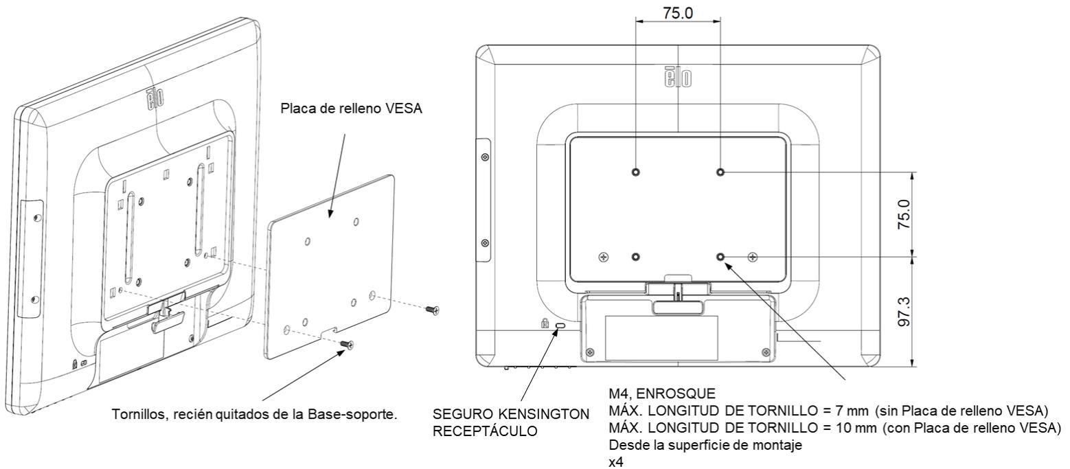
Se suministra para el monitor táctil de 17 pulgadas un patrón de montaje de cuatro orificios de 75x75 mm para tornillos M4 en la parte posterior del mismo. Quite el pedestal utilizando un destornillador Philips para acceder a la interfaz de instalación. Se recomienda instalar la placa de relleno VESA antes de instalar el Montaje en pared. La numeración compatible con VESA FDMI está codificada: VESA MIS-B, 75, C.
