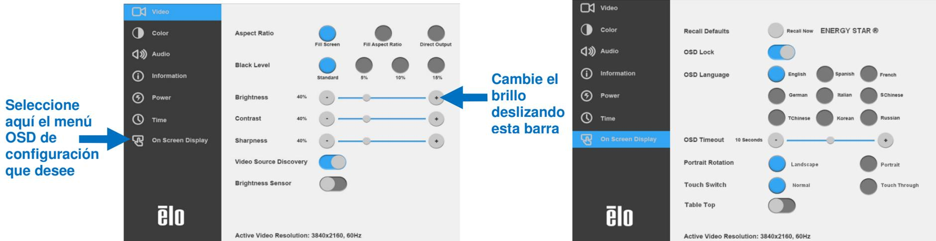
Todos los ajustes de la pantalla IDS realizados mediante el menú OSD se almacenan automáticamente en el momento en el que se introducen. Esta característica le ahorra tener que restablecer sus elecciones cada vez que la pantalla IDS se desenchufa, se apaga y se enciende, o se interrumpe la alimentación.
