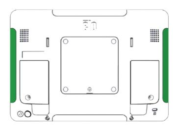
Снимите крышки периферийного устройства Edge Connect, чтобы открылся периферийный отсек. На одном дисплее I-Series 2.0 можно установить не более двух световых индикаторов состояния.
