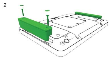
Прикрепите световой индикатор состояния к I-Series 2.0 входящими в комплект винтами и закройте винты крышками
