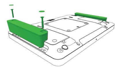
Осторожно прижмите световой индикатор состояния в периферийном отсеке Edge Connect, чтобы закрепить разъем. Затем установите входящие в комплект винты с крышками.
