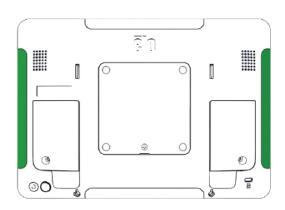
Снимите крышки периферийного устройства Edge Connect, чтобы открылся монтажный интерфейс. На одном дисплее I-Series 2.0 можно установить не более двух световых индикаторов состояния.
