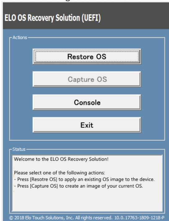
5. Seleccione **Restore OS (Restaurar SO)**. El sistema probará el hardware automáticamente. Cuando el proceso se complete, haga clic en el botón **Start (Iniciar)** para ejecutar la función de recuperación del sistema.
