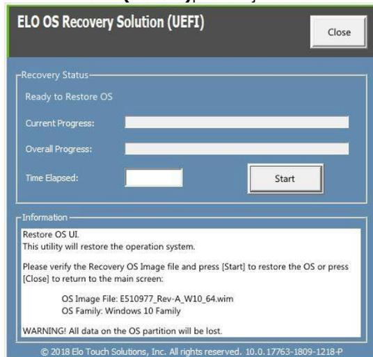
6. El siguiente proceso reformateará la unidad de disco duro principal. Haga una copia de seguridad de los datos antes de realizar el proceso de recuperación.
