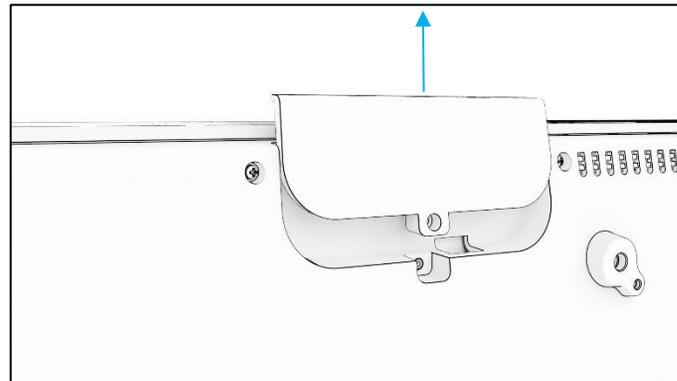
3. 连接扬声器电缆连接器，将连接器安装到新位置。然后将电缆和连接器穿过安装孔，将扬声器从上方滑下，使两个挂钩勾住背面盖板中的插槽。重新拧上安装螺钉。
