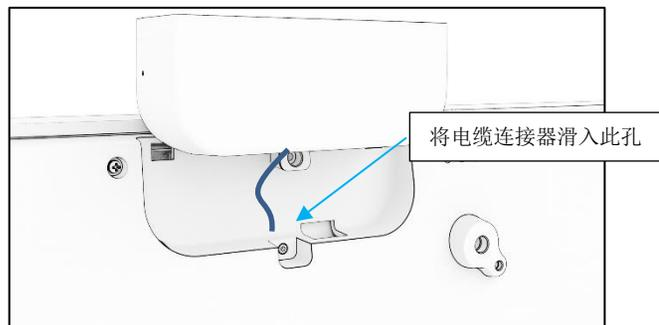
4. 安装第2步中拆下的盖板，将其滑入原扬声器的位置，使挂钩勾住背面盖板中的插槽，然后拧好安装螺钉。
