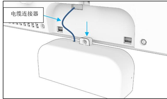
2. 拧下IDS显示器右上方安装盖板上的安装螺钉，并向下滑动盖板，使其脱离安装挂钩。
