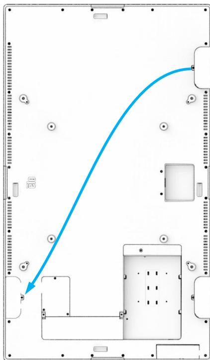
1. 拧下扬声器的安装螺钉并向下滑动扬声器，以使其脱离安装挂钩。向下拉动扬声器，使电缆连接器露出，并使扬声器脱离连接器。
