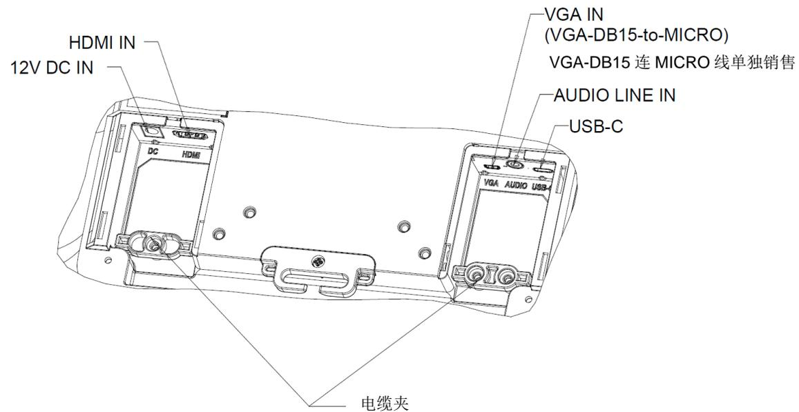
注：扎线点是通过线扣捆扎电缆的位置。只需将线扣穿过扎线点并绕住电缆便可固定电缆连接。
