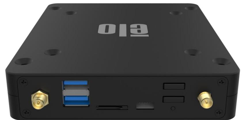
Wi-Fi 和 USB 3.0 microSD GPIO 家用电源 Wi-Fi 和
