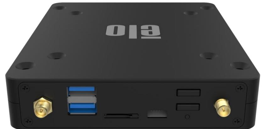
Antenne Wifi et BT   USB 3,0   microSD   GPIO   Accueil Alimentation   Antenne Wifi
