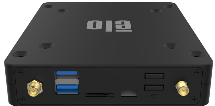
Wi-Fi e antenna Bluetooth   USB 3.0   microSD   GPIO   Alimentazione principale   Antenna Bluetooth
