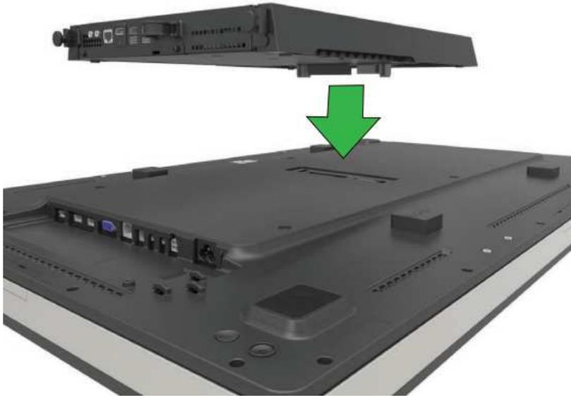
3. Stringere le quattro viti per fissare il modulo computer sul retro del touchmonitor. Montare l'IDS su qualsiasi supporto a parete compatibile VESA tramite i distanziali di espansione e le viti (inclusi).
