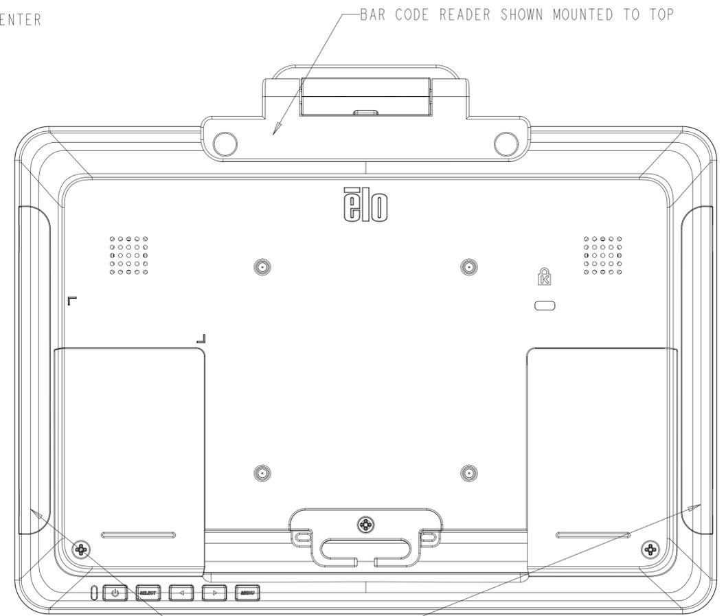
SCANNER HEAD ROTATES 180 DEGREES
