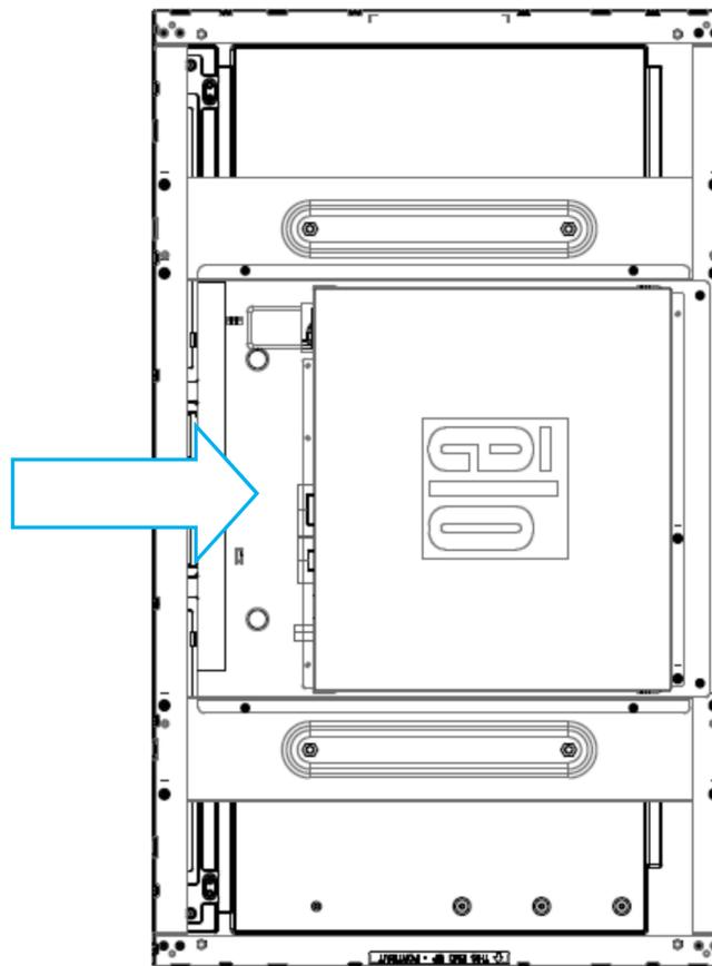
横画面モードは、0度でのみ取り付けることができます。この場合、次の図に示す通り、背面のEloロゴは回転せず、ケーブルは下側から接続されます。
