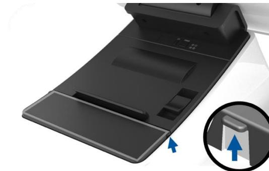
Abbildung 5. Drücken Sie bei einem Papierstau die seitliche Rippe (blauer Pfeil) zum Öffnen der Papierstau-Druckerklappe (hellgrau) nach oben
