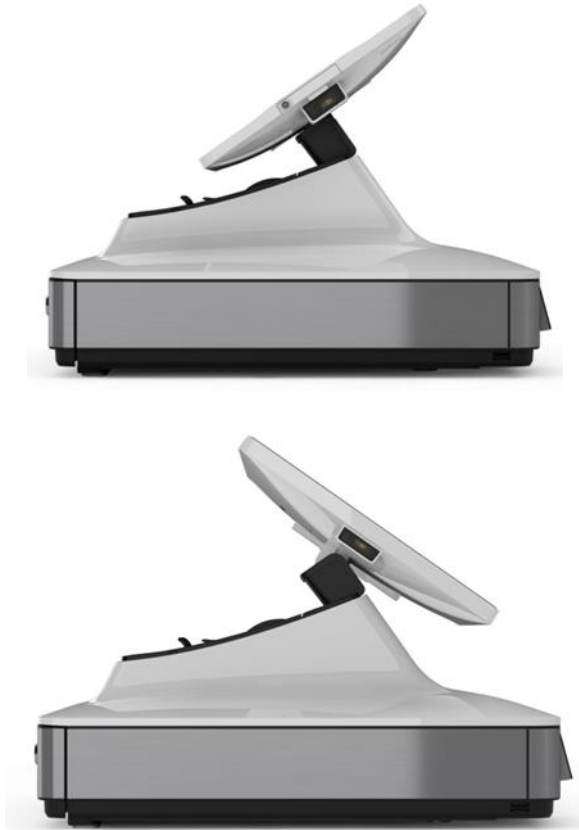
图 3. Elo PayPoint Plus 显示器头可翻转，并支持两种配置： Elo PayPoint Plus 收银机朝向店员侧视图（顶部）和朝向顾客侧视图（底部）
