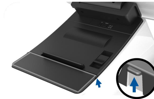
Figura 5. In caso di inceppamento della carta, esercitare una pressione verso l'alto sulla linguetta laterale (freccia blu) per aprire lo sportello della stampante (grigio chiaro)
