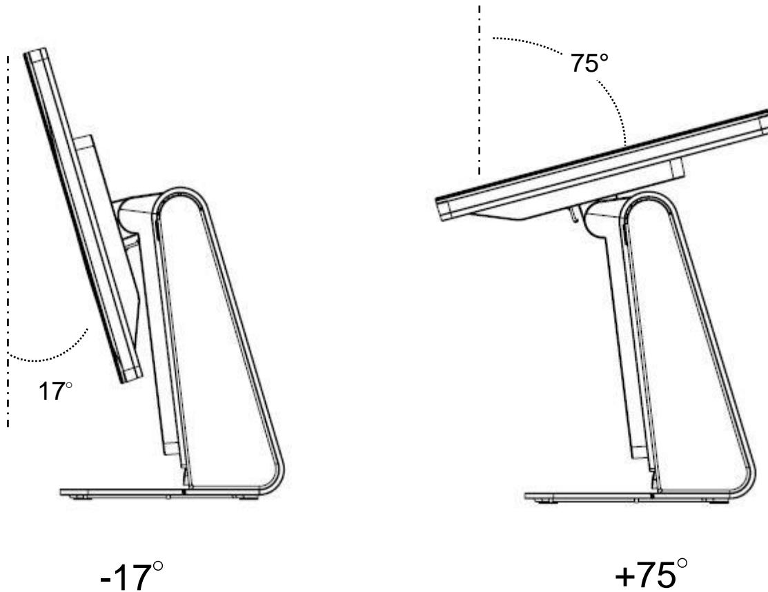
**Осторожны:** Чтобы не допустить опрокидывания или падения компьютера, удерживайте его основание во время регулировки дисплея.
