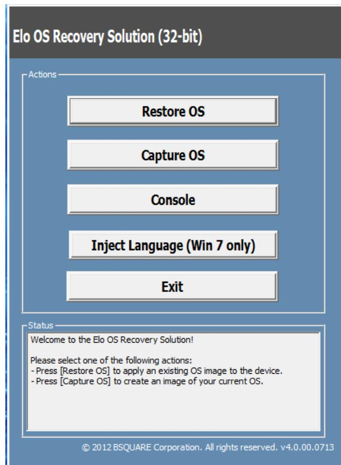
6. 选择**恢复操作系统**。系统将自动测试硬件。在测试完成后，单击**开始**按钮恢复操作系统。
