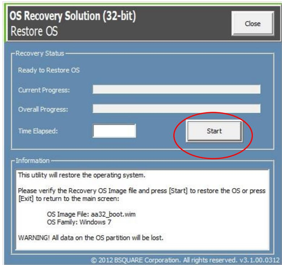
7. 以下步骤将重新格式化主要硬盘。在**恢复操作系统前**，请备份数据。
