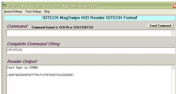
3. Si la identificación de la tarjeta aparece en la ventana Reader Output (Salida del lector), el lector funciona de forma correcta.
