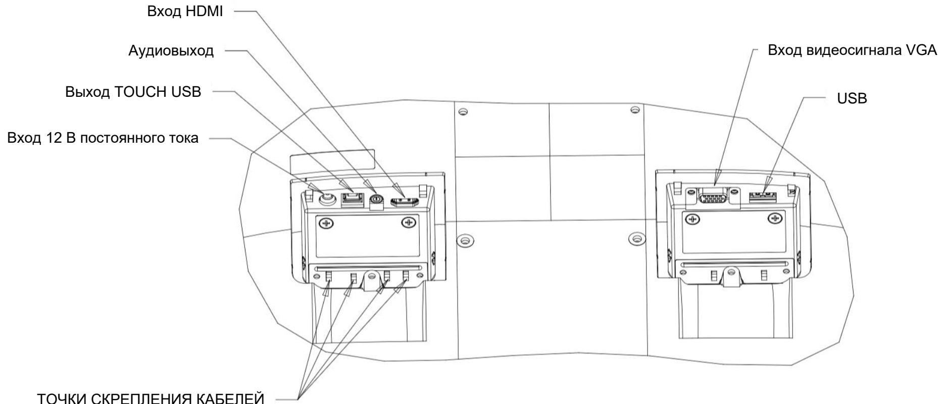
Примечание. Точки скрепления кабелей можно использовать для скрепления кабелей кабельными стяжками. Чтобы стянуть кабели, пропустите кабельные стяжки через точки скрепления кабелей и оберните вокруг кабеля.
