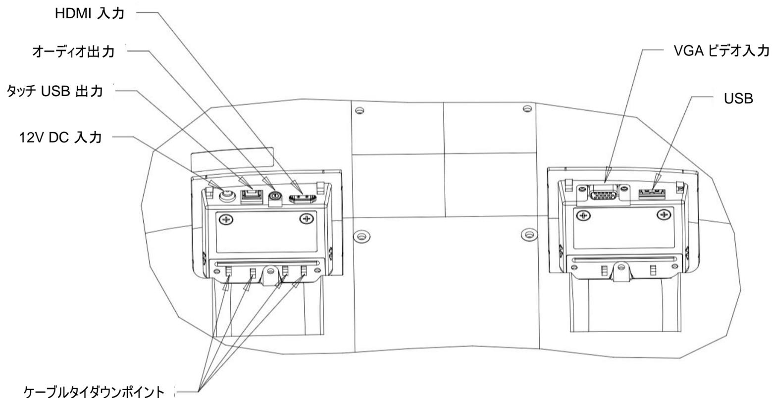
注: ケーブルタイダウンポイントを使用して、ケーブルをタイラップで結ぶことができます。ケーブルタイダウンポイントを通して、ケーブルの周りにタイラップを巻き付けて、ケーブル接続を固定します。
