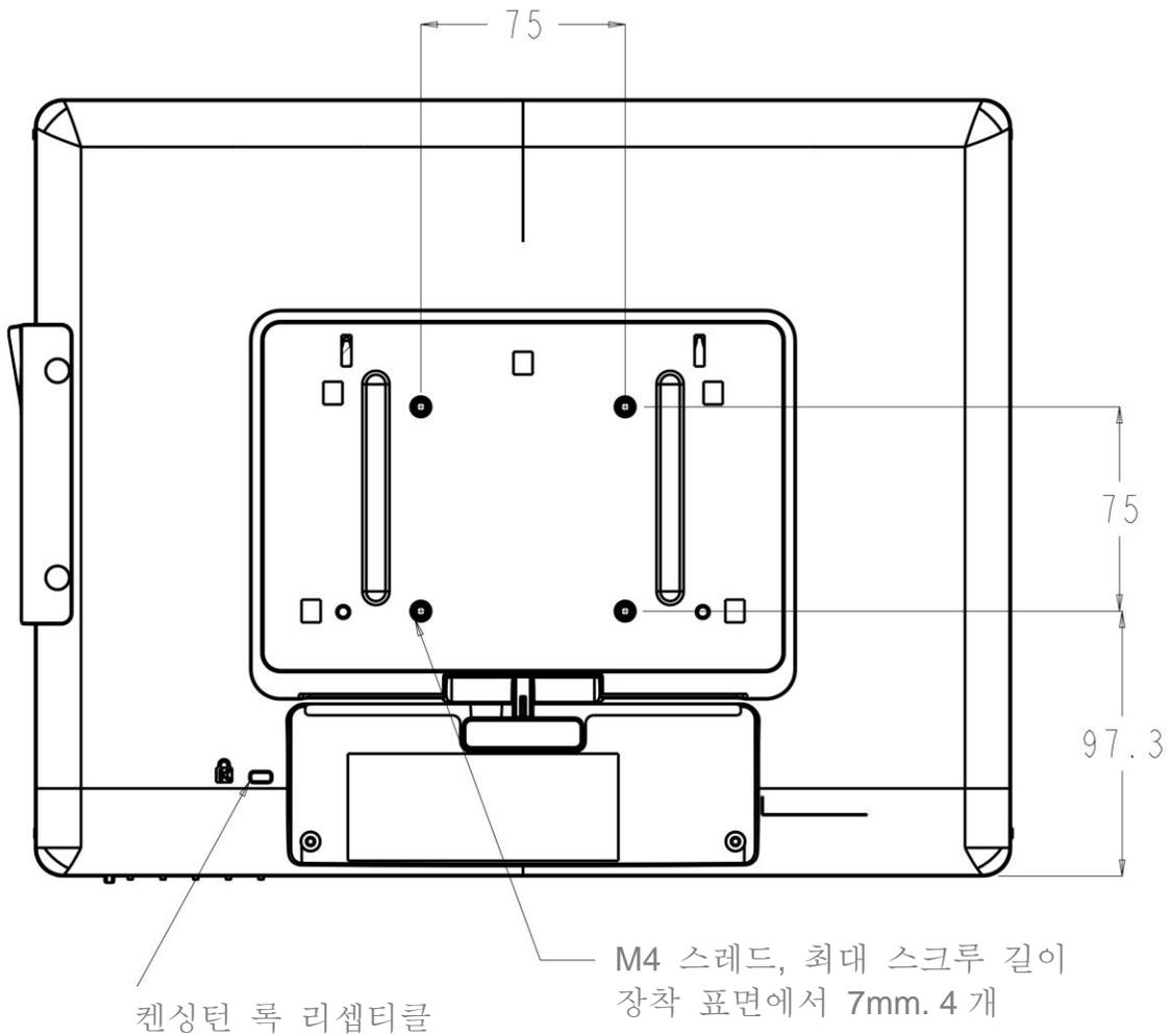
17 인치 터치모니터의 경우, 4개의 구멍이 있는 M4 스크류용 75x75mm 장착 패턴이 모니터의 후면에 제공됩니다. 필립스 스크루드라이버를 사용해서 스탠드를 제거하면 이 장착 인터페이스에 접근할 수 있습니다. VESA FDMI-준수 장착 코드는 다음과 같습니다: VESA MIS-B, 75, C.
