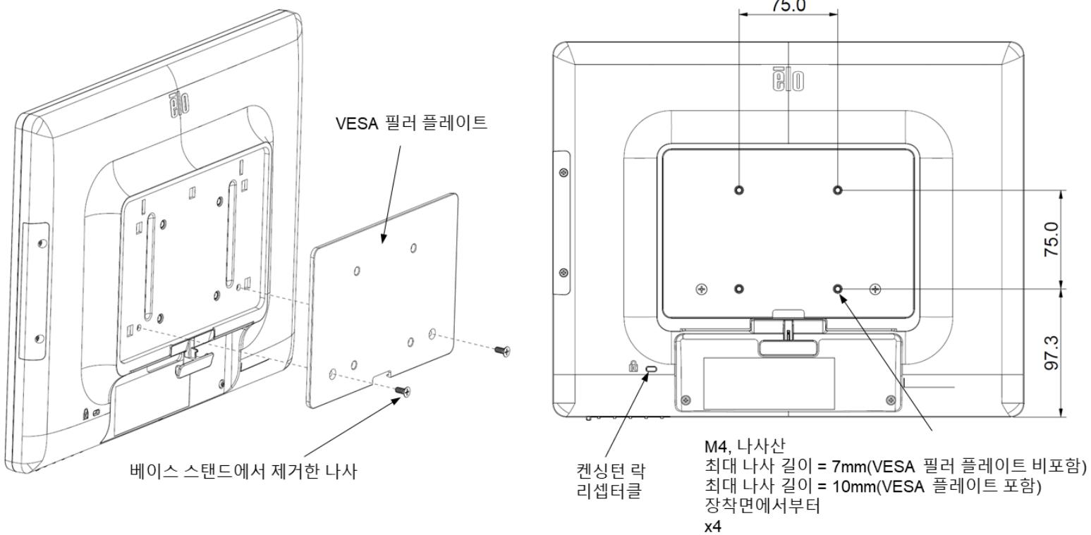
17 인치 터치모니터의 경우, 4개의 구멍이 있는 M4 스크루용 75x75mm 장착 패턴이 모니터의 후면에 제공됩니다. 필립스 스크루드라이버를 사용해서 스탠드를 제거하면 이 장착 인터페이스에 접근할 수 있습니다. 벽 장착을 하기 전에 VESA 필러 플레이트를 설치할 것을 권장합니다. VESA FDMI-준수 장착 코드는 다음과 같습니다: VESA MIS-B, 75, C.
