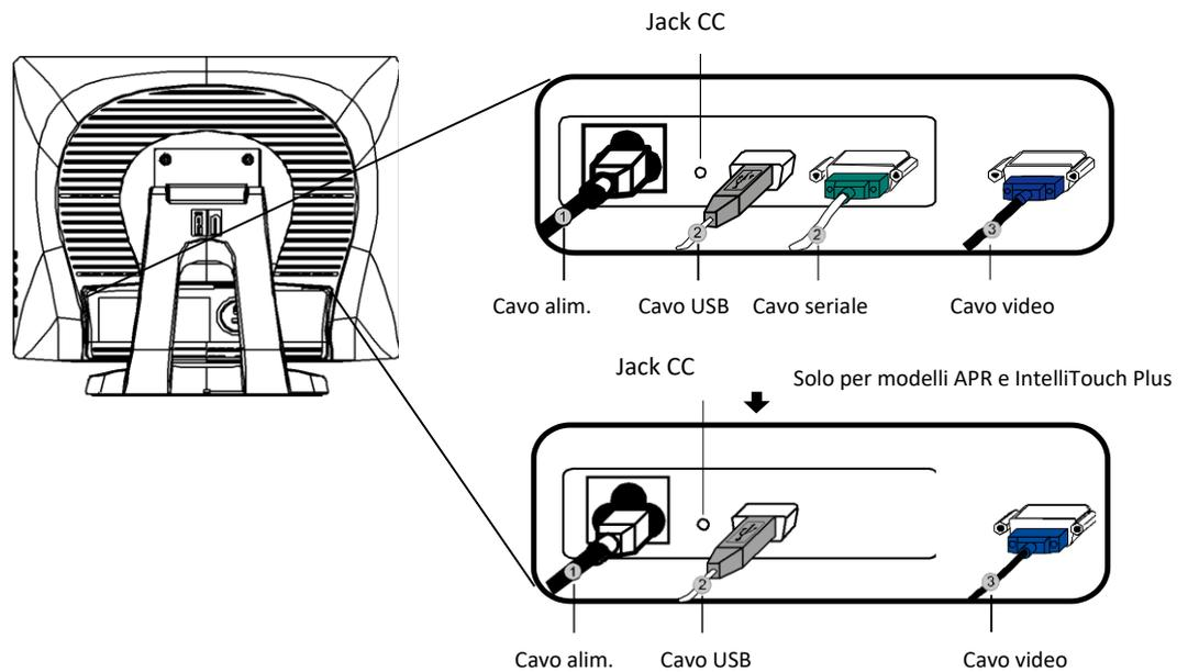
1. Collegare un'estremità del **cavo di alimentazione** al monitor e l'altra estremità alla presa di corrente.
