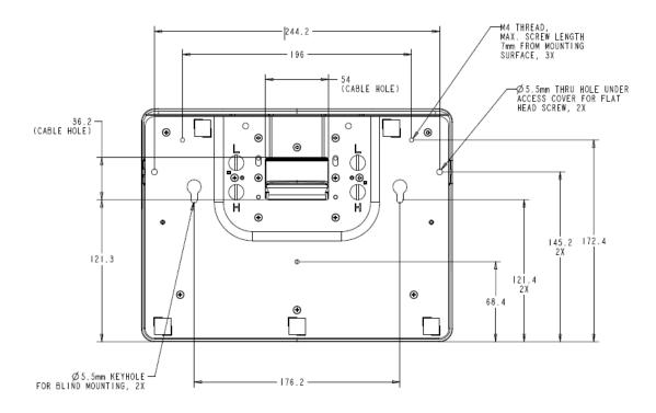
Beim 2002L-Touchmonitor werden an der Unterseite der Basis zur Montage und Befestigung Durchgangslöcher mit Gewinde bereitgestellt.
