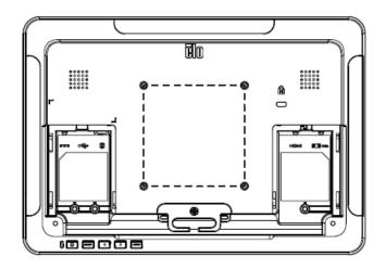
Für den 1502L & 2002L-Touchmonitor gibt es an seiner Rückseite ein Montagemuster für M4-Schrauben bestehend aus vier Löchern in 75 x 75 mm und 100 x 100 mm. Für den Zugriff auf diese Befestigungsschnittstelle entfernen Sie den Standfuß mit einem Kreuzschlitzschraubendreher. Der FDMI-kompatible Zählcode für den VESA-Standard lautet: VESA MIS-B, 75, C sowie VESA MIS-B, 100, C.
