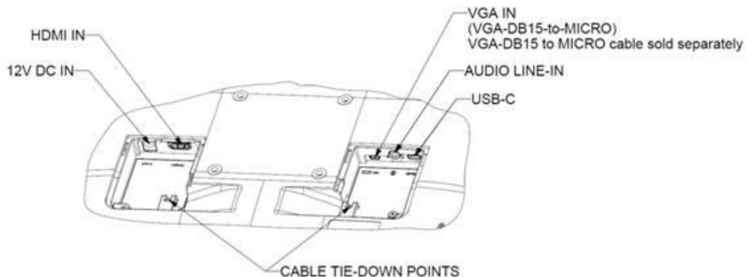
Примечание. Точки скрепления кабелей можно использовать для скрепления кабелей кабельными стяжками. Чтобы стянуть кабели, пропустите
